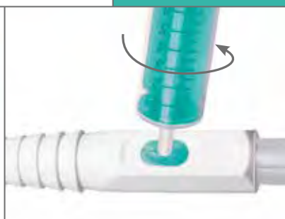
Konnektor mit nadelfreier Urinprobeentnahmestelle zur sicheren Entnahme der Urinprobe ohne das Risiko einer Stichverletzung
